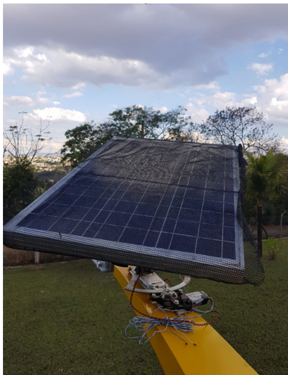
FIGURA 6 – Poste Fotovoltáico com Sombrite.
