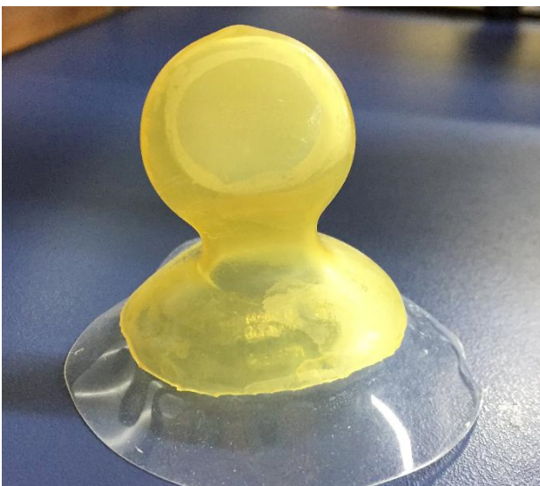
Figura 3 – Molde inicial: Junção do bico com o intermediário.
