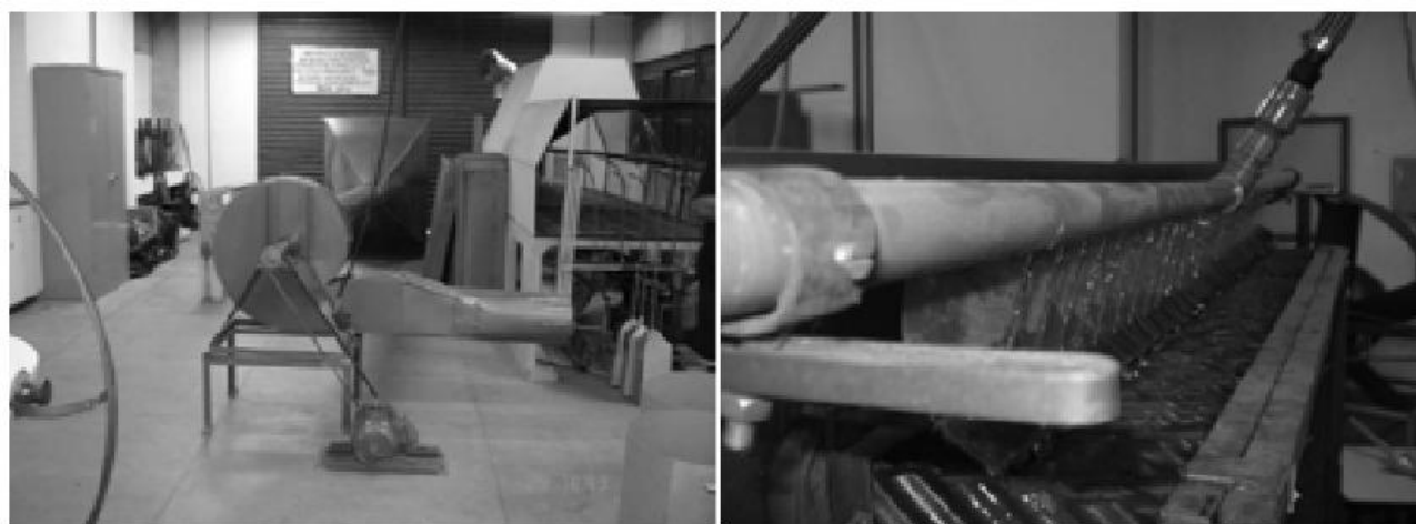
Figura 2 - Túnel de vento (a) - vista traseira; (b) – Sistema de abastecimento de água.
