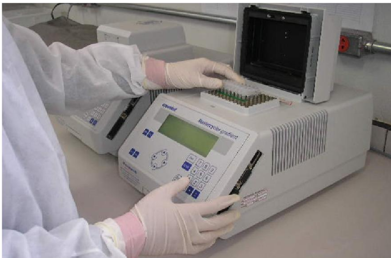
Figura 1: Ilustração do termociclador para a Reação em Cadeia Polimerase (PCR).
