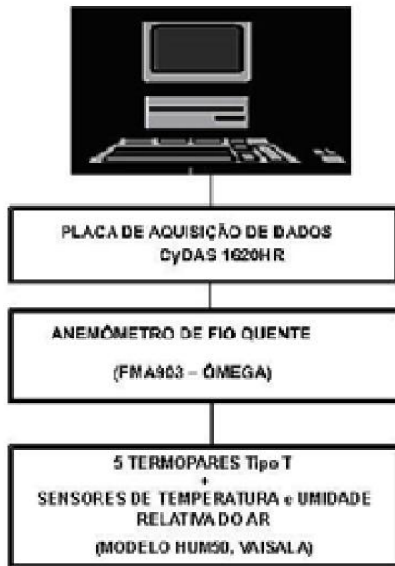
Figura 3 - Esquema do Sistema de Aquisição de Dados Utilizado na Pesquisa.
