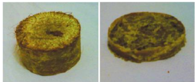
Figura 3 Amostra confeccionada com fibra triturada (Tipo 1)
