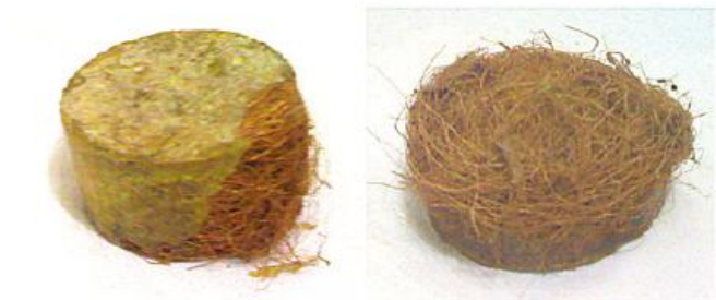
Figura 4-Amostras confeccionadas com fibra em fios (Tipo 2)
